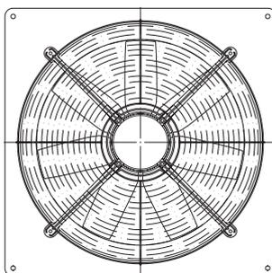
Abb. 2 Bauform Q mit saugseitigem Berührschutzgitter
