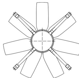
Abb. 3 Bauform T für Einbau in Abluftkamine
